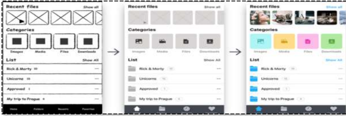
الشكل رقم (17) نموذج أولي لموقع الويب باستخدام تصميم عالي التفصيل. المصدر: إعداد الباحث بالاعتماد على مصادر وردت في نهاية الكتاب(5-6).
